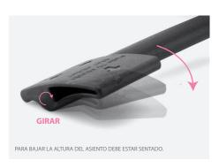
Para activar el **slider**, mantenga presionada la palanca hacia arriba. Una vez liberado el slider podrá mover el asiento a la posición deseada. Al soltar la palanca se fijará la posición seleccionada.
